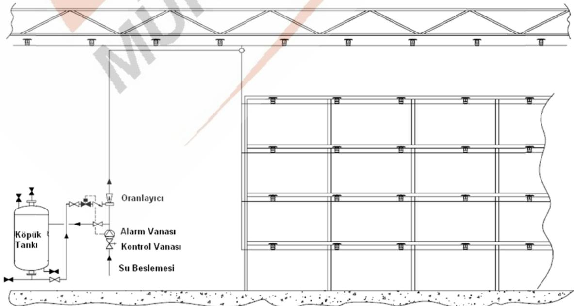
**Şekil 3. Islak Borulu Köpüklü Söndürme Sistem Şeması**
